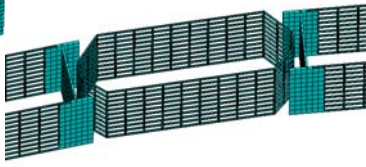
图 11-36 工字形型钢与钢筋关系
