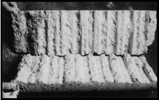
图 11-22 铣槽机切削形成的一期混凝土表面
