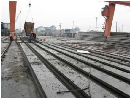
图 15-12a 板桩制作图
